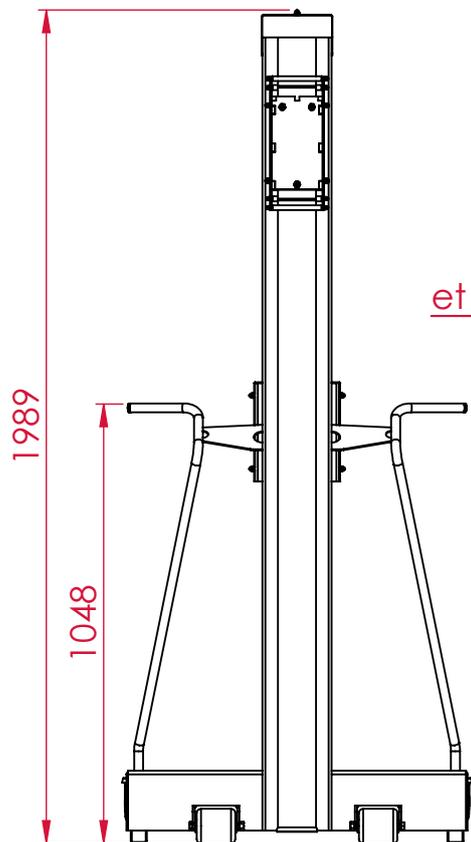
Treuil de levage en acier zingué et poignée en inox
